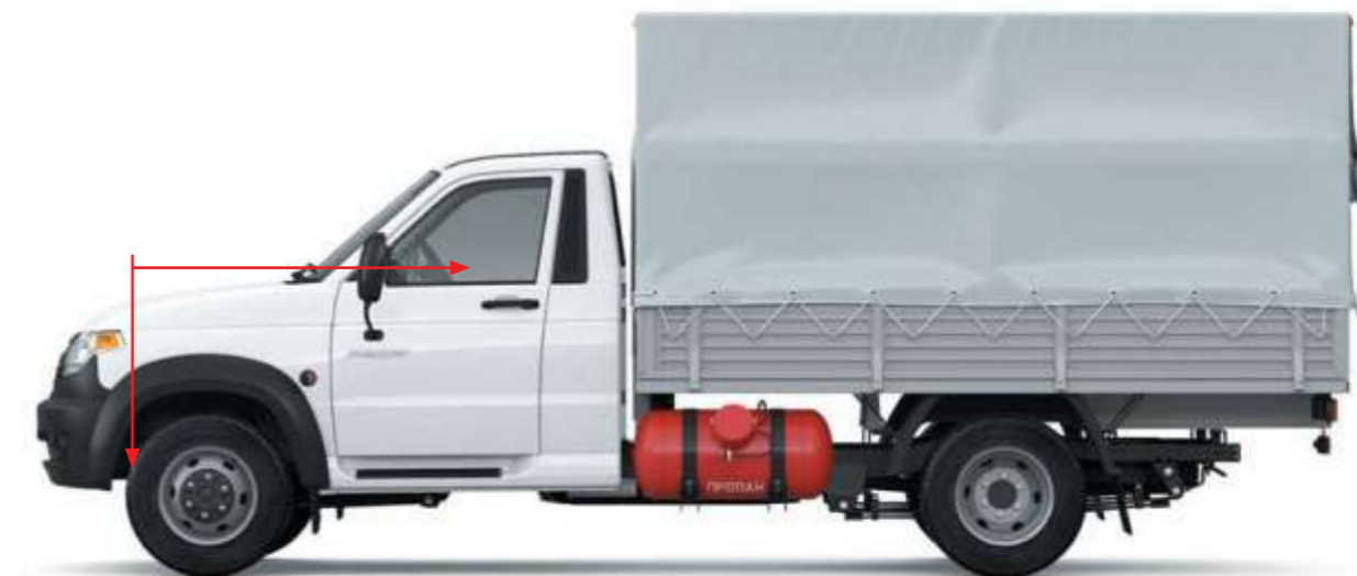
Капотная компоновка обеспечивает большую безопасность водителя при лобовом столкновении
